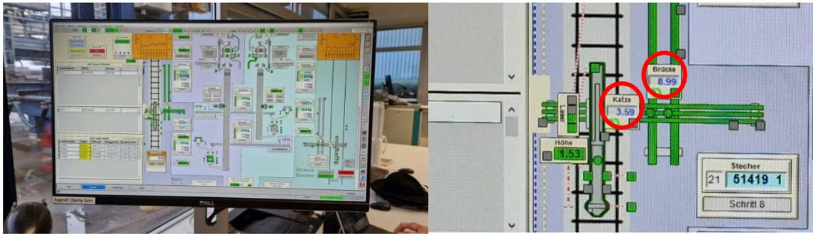
Abbildung 6: Anzeigebildschirm für den Probenahmeprozess (links) mit Ausschnitt der Darstellung des Probestechers mit Angabe der Koordinaten (rechts, rote Kreise).
