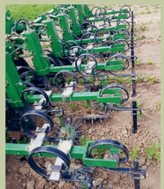
Die flexiblen Fingerhacken ermöglichen das Hacken in den Reihen ab ca. 4-Blatt-Stadium.
